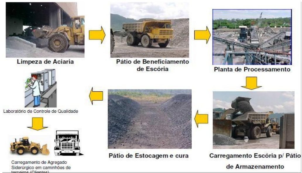
Figura 6 Fluxo do processo de beneficiamento da escória de aciaria Fonte: RAMOS, 2008.
