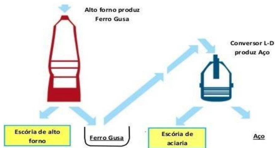
Figura 4 Produção da Escória de Alto Forno e da Escória de Aciaria Fonte: THOMAZ, 2012.
