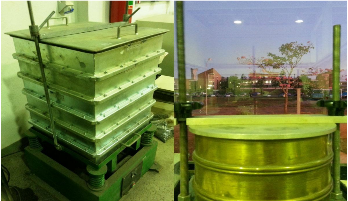
Figura 8 Peneiramento dos Agregados Fonte: Autores.
